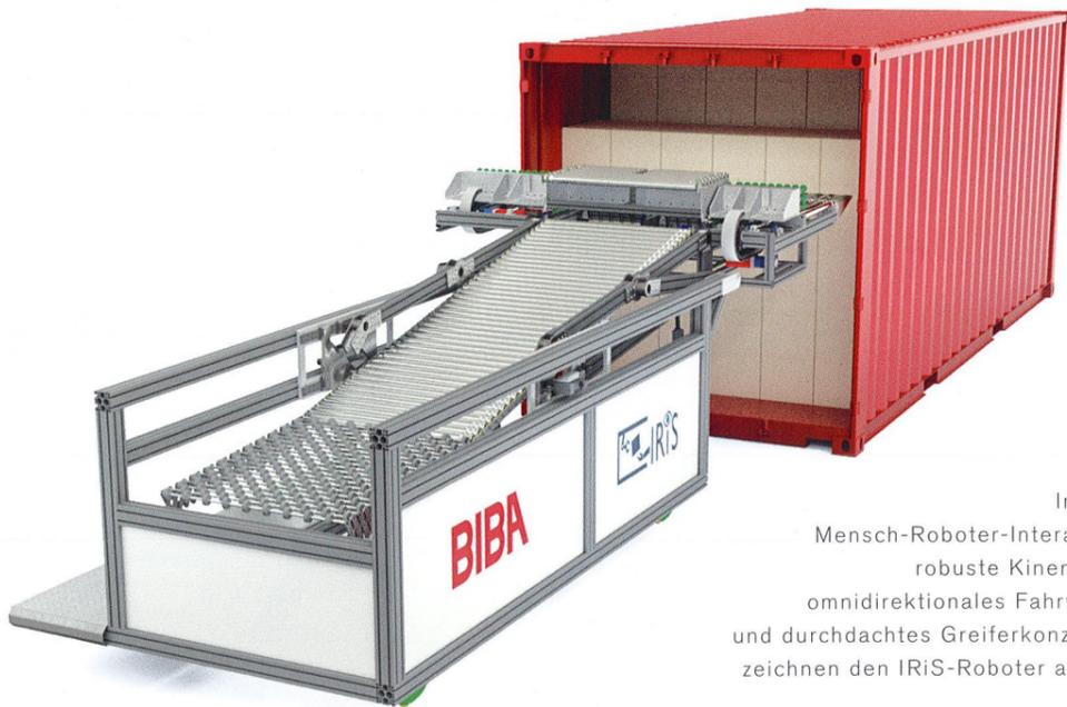
Intuitive Mensch-Roboter-Interaktion, robuste Kinematik, omnidirektionales Fahrwerk und durchdachtes Greiferkonzept zeichnen den IRiS-Roboter aus.
